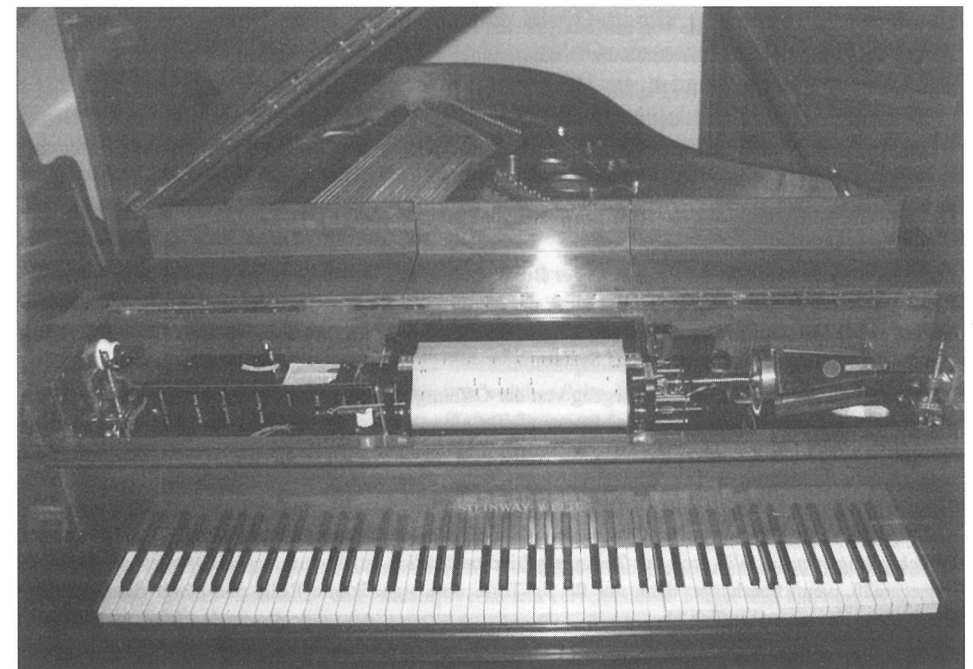
Abb. 2 (unten): Eine Rolle beim Abspielen. Wie man auch an den heruntergedrückten Tasten sehen kann, wird gerade der auf Seite 152 besprochene Akkord abgespielt. Normalerweise werden beim Abspielen die drei Abdeckklappen geschlossen, so daß man von der Technik nichts sieht.
